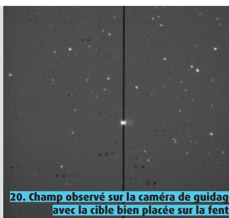
20. Champ observé sur la caméra de guidage, avec la cible bien placée sur la fente.
